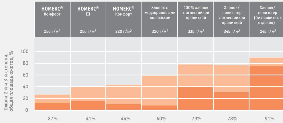
2. Значения получены при испытании в соответствии со стандартом ISO 13506. В ходе испытаний комбинезоны одной модели и размера, изготовленные из тканей разного типа и веса (надеваемые вместе со стандартным хлопчатобумажным нижним бельем с короткими рукавами) подвергаются воздействию тепловой энергии на уровне 2 кал/см<sup>2</sup>/с в течение 4 секунд. Процент ожогов включает 7% ожогов тела, приходящихся на незащищенную голову.
